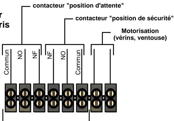
Raccordement doublé en cas de contacteurs bipolaires
