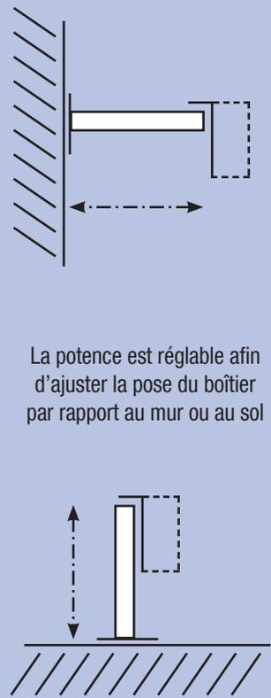
La potence est réglable afin d'ajuster la pose du boîtier par rapport au mur ou au sol
